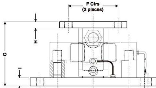
每个模块由底板组件、顶板组件、加载销和支架、底销、安装杆、固定夹和带有螺钉和垫圈的接地带组成。
